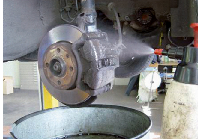
Abb. 17-7 Besprühen eines Bremssattels
