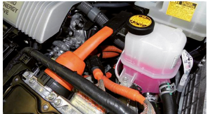
Abb. 8-1 Orange gekennzeichnete HV-Kabel
